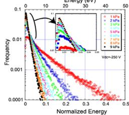
水素イオンはシース(プラズマと基板との間の空間)中での衝突によりエネルギーの大半を失う。この結果は、既存の運動量による核形成促進モデルに修正を迫るものである。
