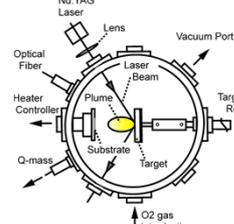
Nd:YAGレーザー源を有するパルスレーザー蒸着装置。意図しない不純物の混入を極力避けるため、 $10^{-7}$  Paの背圧を維持している。
