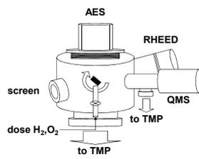
表面分析のための超高真空槽。背圧は $10^{-9}$  Paに達する。RHEED, AES, QMSとガスクラッキング機構により表面の構造、化学結合種、脱離種の計測が可能となる。
