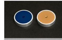
DLCがコーティングされたアルミ合金製機械摺動部品。色の違いは膜厚に依存した干渉により生じている。これはDLCが可視光領域で透明であることを示している。
