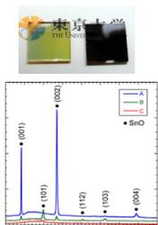
SnとOラックスの制御により、ガラス上にも結晶配向したSnO薄膜が得られる。
