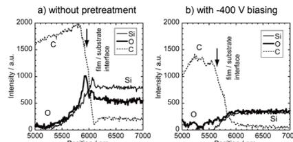
AES(オーージェ電子分光)により計測された界面における深さ方向のC, O, Siの組成分布。堆積前の基板負バイアス印加(b)により界面の酸素が除去されていることがわかる。(b)におけるC濃度のゆるやかな変化はCとSiの混合層が界面に形成されていることを示唆している。
