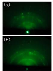
酸素中での熱処理の(a)前と(b)後でのRHEED像。COとして脱離に伴い、表面の結晶構造が乱れていることがわかる。
