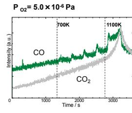
酸素雰囲気での熱処理におけるダイヤモンド表面からの脱離種。ダイヤモンドを終端した酸素がO<sub>2</sub>の形で可逆的に脱離することは無く、必ず表面のエッチングを伴い、COとして脱離する。
