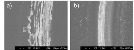
DLC/Al合金摺動部品に対するボール・オン・ディスク試験のボール摺動痕。界面が弱い通常の試料(a)では膜は界面から膜厚を保ったまま剥離している。他方、特定の処理を施した後に堆積した薄膜(b)においては、そのような膜の剥離は見られない。
