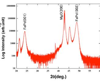
Feシード層およびAu凝集層の堆積により、単結晶MgO基板上に形成された数十nmのFePdナノドット薄膜。AFM像とXRDパターンから均質なナノドット構造と結晶配向性が確認できる。
