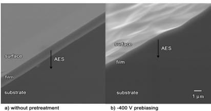
DLC/Si界面の断面SEM像。基板の前処理を行うことにより、明瞭な界面が消失し、膜が連続的に基板への移行していることがわかる。
