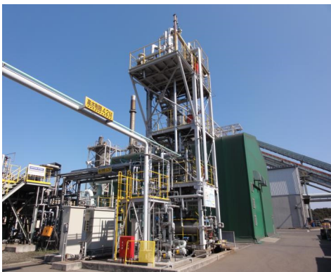
バイオエタノール製造用自己熱再生型蒸留装置 新日鉄住金エンジニアリング株式会社 北九州環境技術センター
