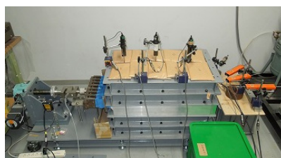
新しく開発したジオセルを用いた補強土擁壁の耐震性に関する研究 補強効果を引抜き試験と振動台模型実験で検討
